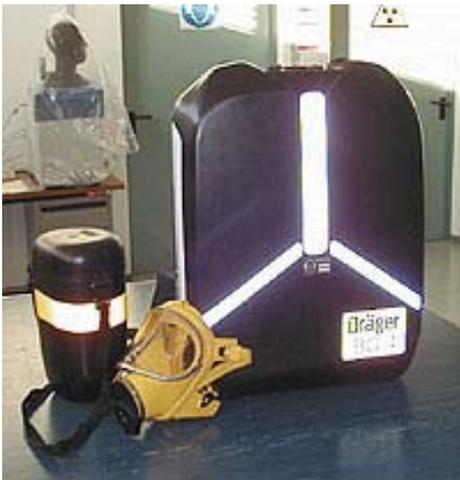
Vengono utilizzati dai Vigili del Fuoco solo in determinate condizioni, sono costituiti da una bombola caricata ad ossigeno puro, e l'aria respirata viene riutilizzata dal sistema e miscelata con l'ossigeno fresco, al fine di ripristinare i parametri di aria respirabile. Il vantaggio principale di tale sistema sta nella durata di utilizzo, l'ossigeno presente nella bombola serve solamente per compensare la perdita del 5% dovuta alla respirazione.
