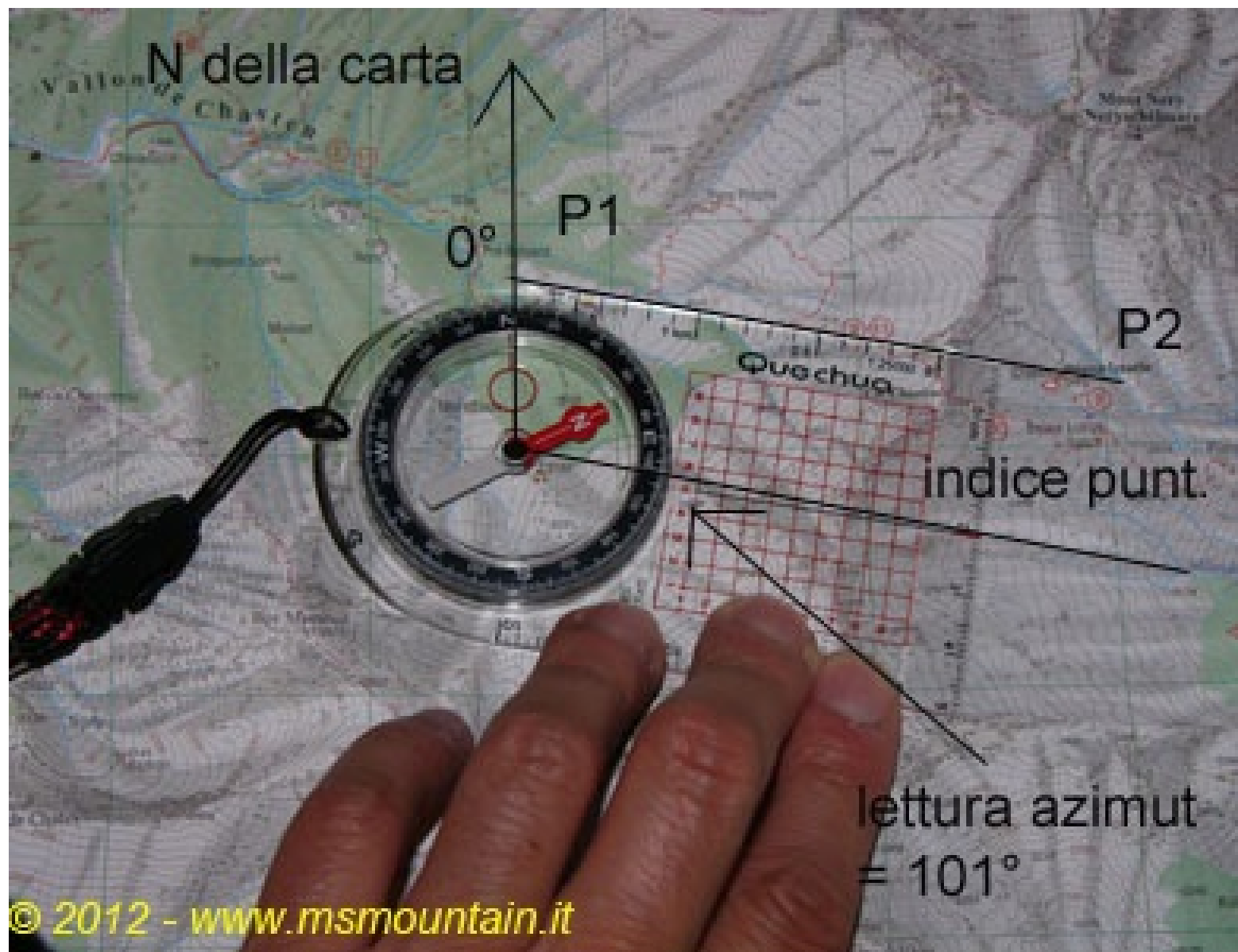
Misura dell'azimut su carta con la bussola da carteggio
