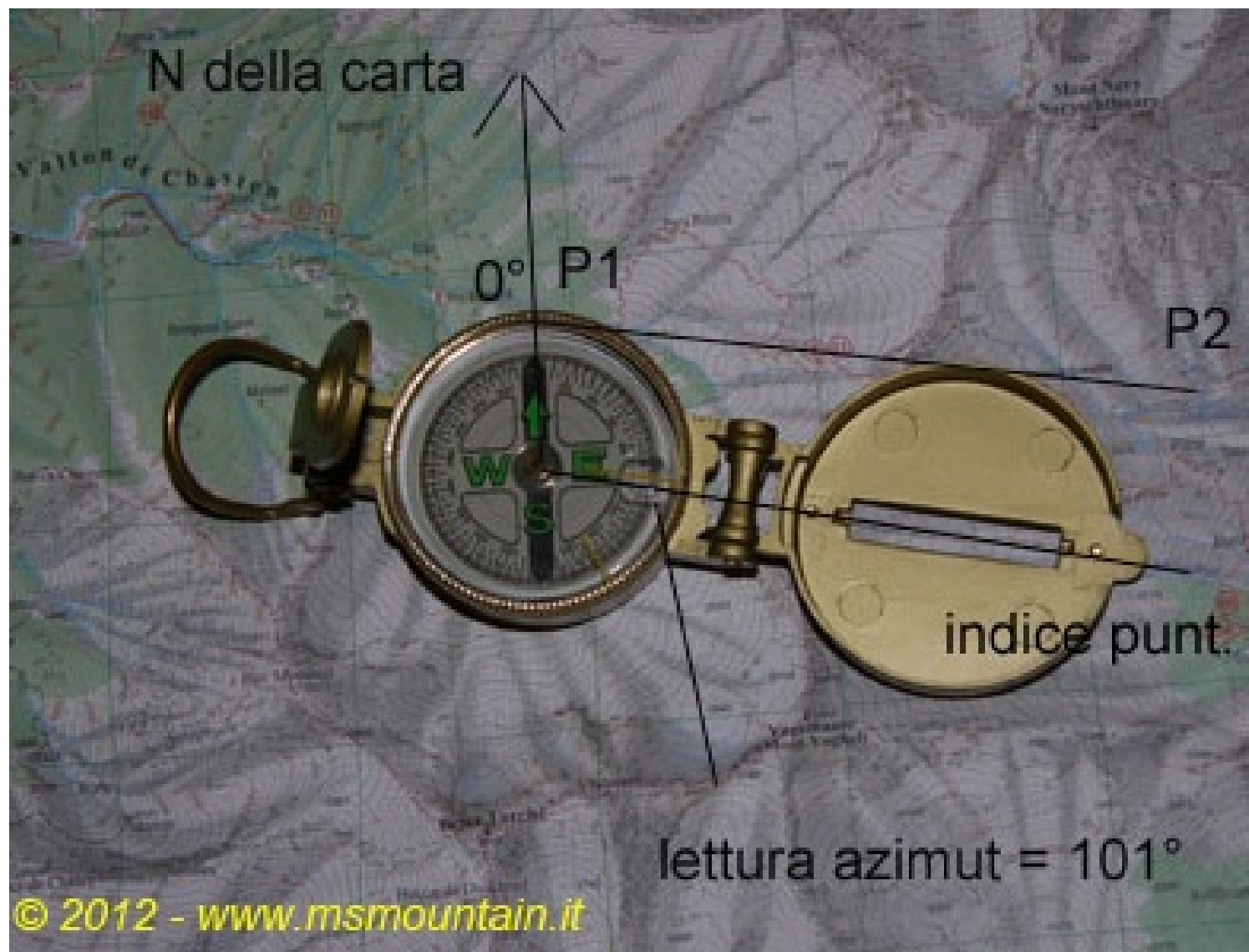
Misura dell'azimut su carta con la bussola da rilevamento
