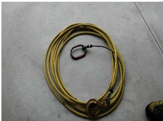
**Fune:** *Le funi utilizzate per l'attacco dei carichi e/o dei moduli sono del tipo ad alta resistenza (Perlon) di varia lunghezza;*
