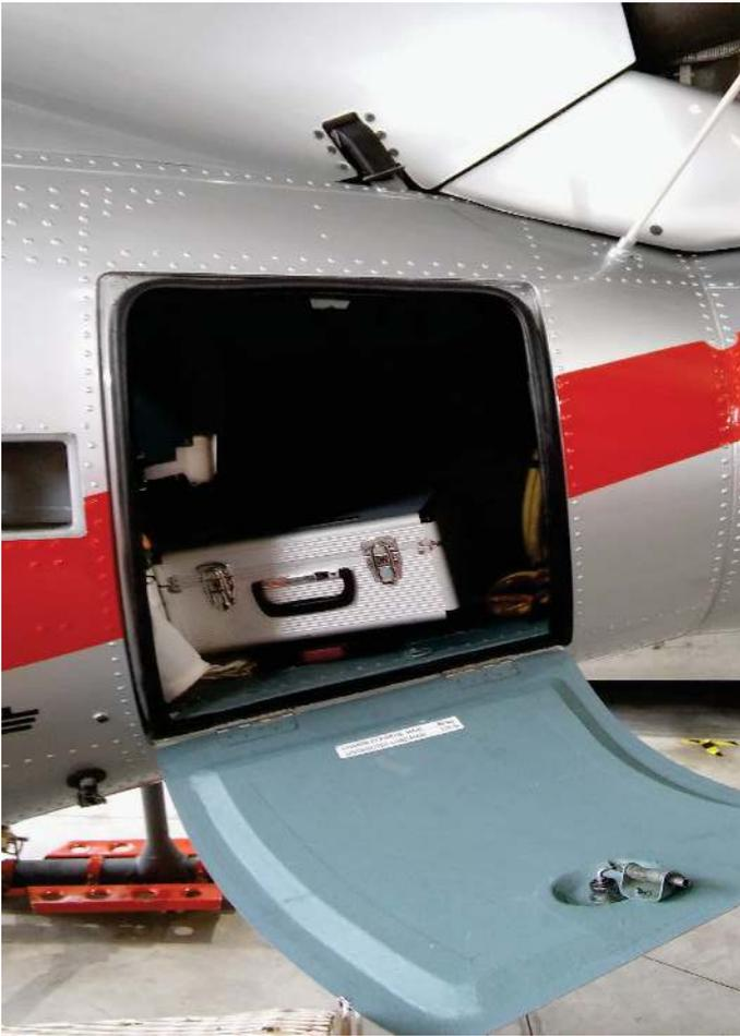
Tra il vano motore e la trave di coda vi è il cosiddetto «vano di coda» dove di solito vengono riposte dotazioni aggiuntive: funi, cassetta attrezzi, attrezzature per la gestione del mezzo ed eventualmente dotazioni di emergenza in caso di incidente.
